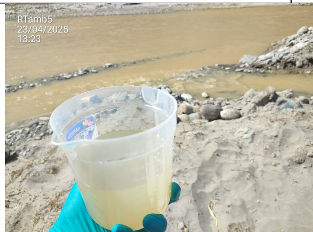
Foto N° 129 y 130: Muestra de agua del punto RTamb5. El cuerpo de agua tiene una coloración ligeramente amarilla, con presencia de sólidos suspendidos. Se tuvo participación de la Municipalidad Distrital de Cocachacra.
