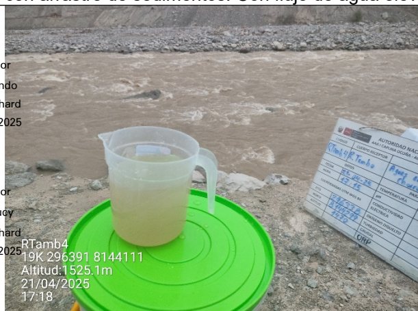
Foto N°125 y 126: Muestra de agua superficial del punto RTamb4, con elevada presencia de partículas suspendidas. A la derecha se aprecia al equipo técnico del ALA Tambo Alto Tambo.
