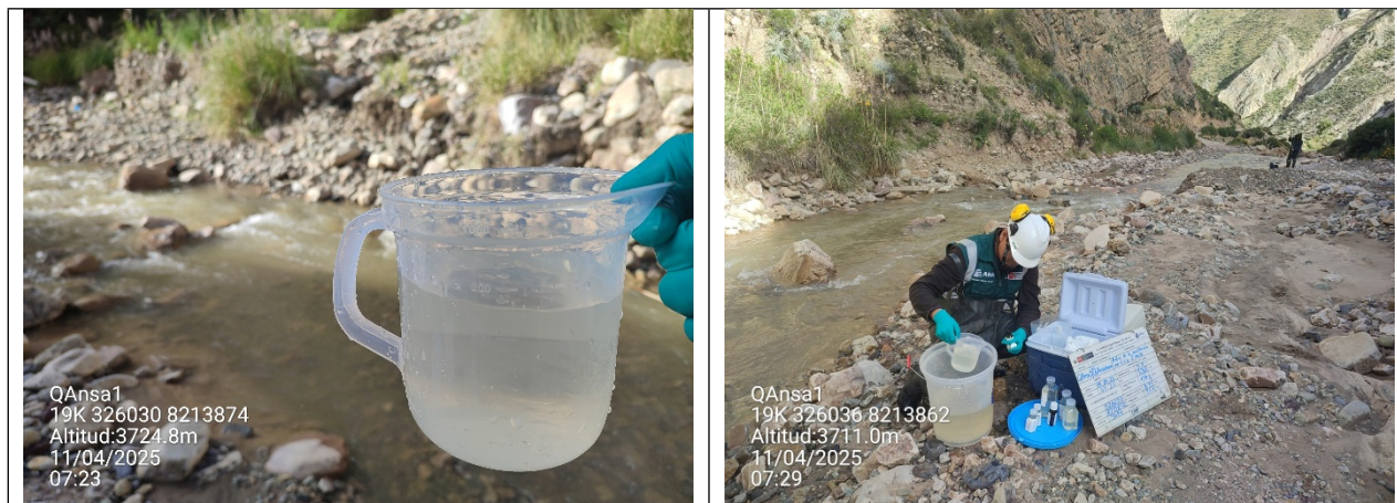
Foto N° 025 y 026: Muestra de agua superficial del punto QAnsa1, en la ella se logra visualizar ligera turbidez, debido a la presencia de partículas finas en suspensión. Toma de muestras de agua en frascos proporcionados por el laboratorio SGS del Perú SAC
