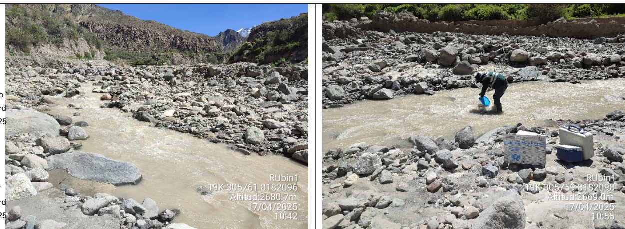
Foto N° 112 y 113: punto RUBin1, (Río Ubinas) antes de la confluencia con el río Tambo. Cuerpo de agua con coloración marrón claro debido a la alta presencia de sólidos en suspensión, que se origina por el arrastre de sedimentos
