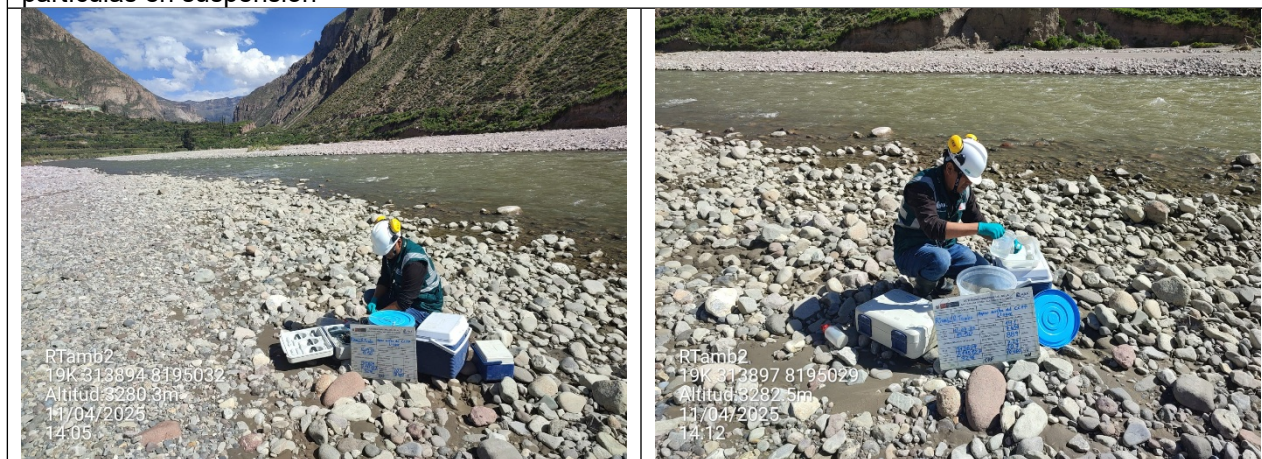
Foto N° 031 y 032: Punto de monitoreo RTamb2, en las fotos se aprecia parte del proceso del monitoreo: medición de parámetros de campo y preservación de muestras. No se tuvo participación de la comunidad.
