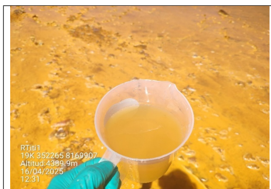
Foto N° 068: Muestra de agua del punto RTiti1. El agua presenta una coloración amarillo naranja con alta presencia de partículas finas suspendidas.
