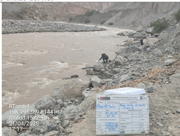
Foto N° 123 y 124: Punto de monitoreo RTamb4, (Río Tambo) aguas arriba de puente Chorro. Agua turbia, con arrastre de sedimentos. Con flujo de agua elevado.
