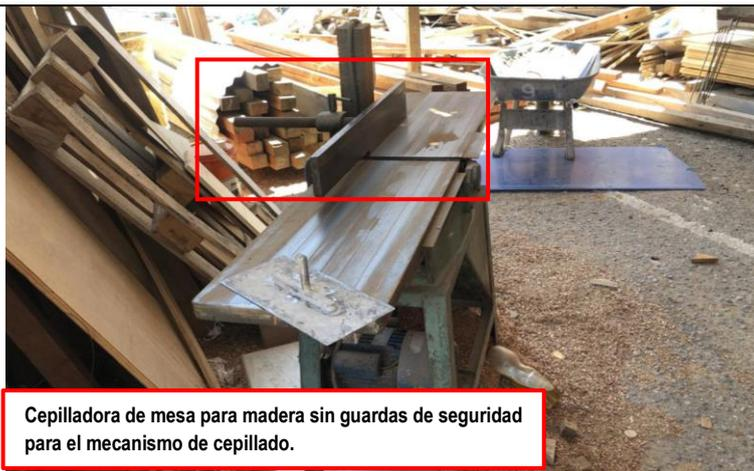
**Cepilladora de mesa para madera sin guardas de seguridad para el mecanismo de cepillado.**
