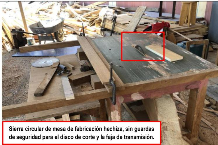
**Sierra circular de mesa de fabricación hechiza, sin guardas de seguridad para el disco de corte y la faja de transmisión.**
