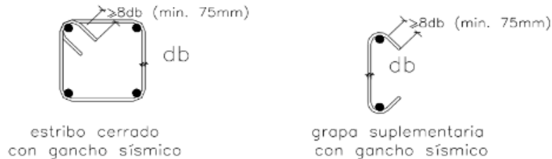
Fig. 21.1d Ganchos sísmicos en estribos y grapas suplementarias
