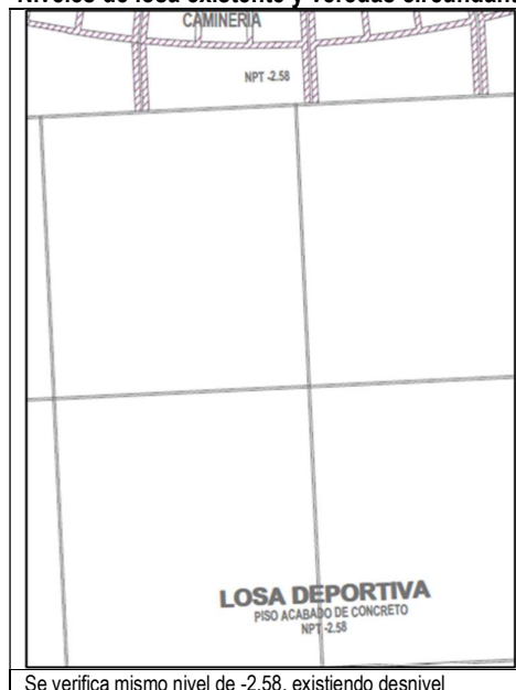
Imagen n.º 11 Niveles de losa existente y veredas circundante
