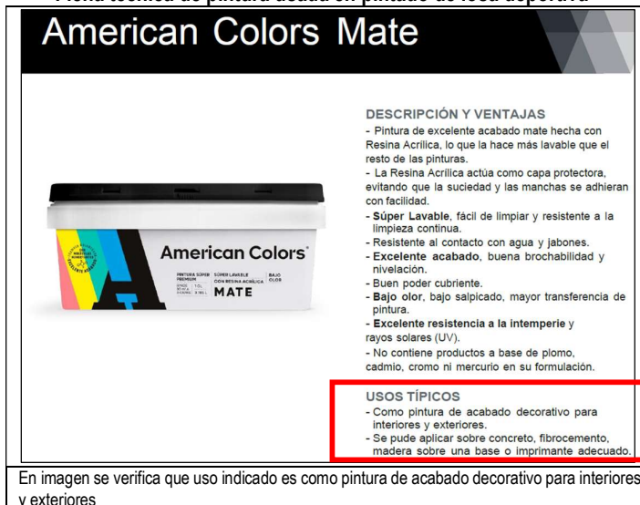
Imagen n.º 6 Ficha técnica de pintura usada en pintado de losa deportiva
