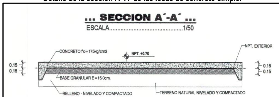
Imagen n.º 53 Detalle de la sección A'-A' de las losas de concreto simple.
