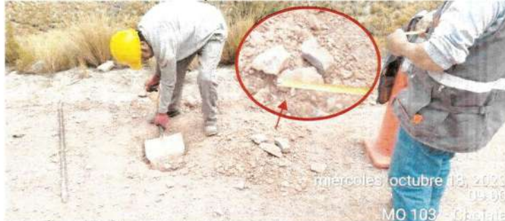
Imagen n.° 12 Extracción de muestra en la progresiva 5+860 Tramo Emp. MO-103 – Pachas
