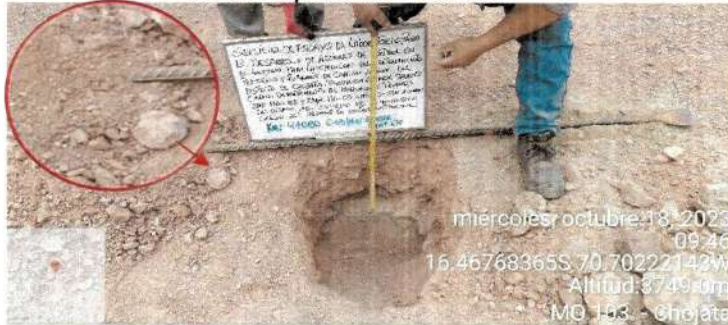
Imagen n.º 10 Extracción de muestra en la progresiva 4+080 Tramo Emp. MO-103 – Pachas
