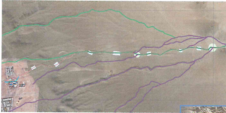
Figura 3: Zonas para reforzar (círculos), zonas de disipación de energía.
